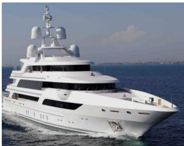
Benetti FB264 è equipaggiato con 2 motori MTU - 12V 4000 M53 1380 kW @ 1800 rpm per una velocità massima di 15.5 nodi ed un'autonomia di 4.750 miglia, viaggiando ad una velocità di 12 nodi.
