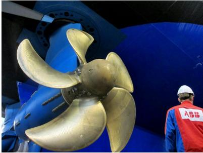
**Unità ABB Azipod in un cantiere navale**
