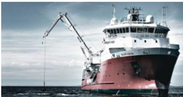
Sono inoltre garantiti tutti i requirement previsti dalle normative offshore come l'Automatic Overload Protection System (AOPS) sistema automatico a protezione del superamento del carico che interviene rilasciando la fune evitando danni alle strutture o all'imbarcazione e il Manual Overload Protection System (MOPS) sistema a protezione del superamento del carico che viene azionato manualmente anche in caso di problemi all'impianto di automazione.
