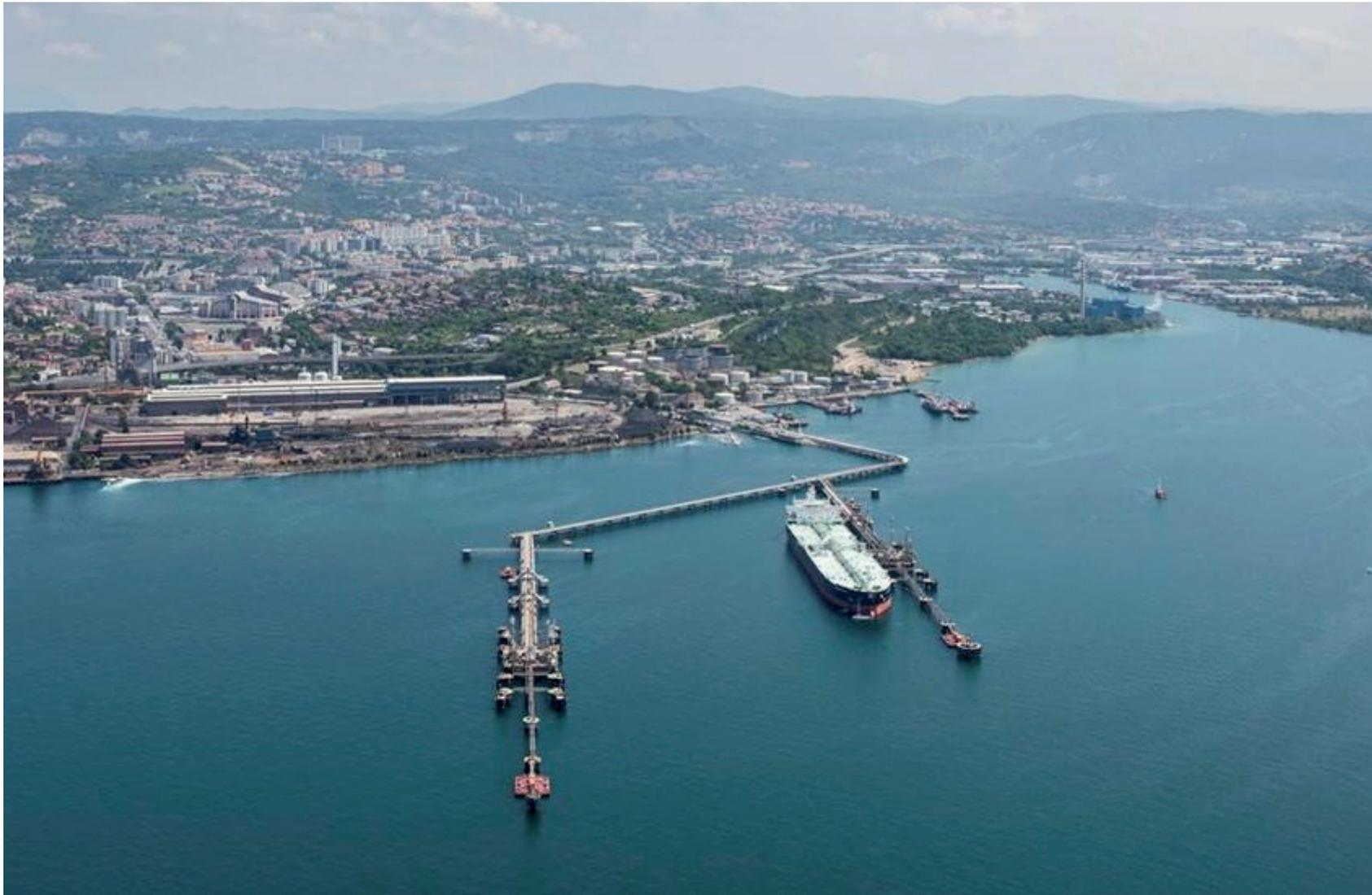
Il Terminale Marino è il punto d'inizio del sistema TAL: il greggio scaricato viene trasferito al Deposito costiero di olii minerali da dove viene trasportato tramite l'Oleodotto Transalpino alle raffinerie collegate.
